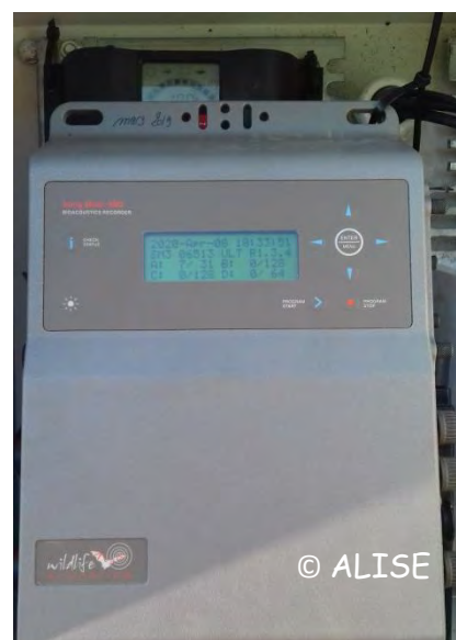
Photo 4 : Boîtier SM3BAT+ pour l'écoute passive en hauteur
