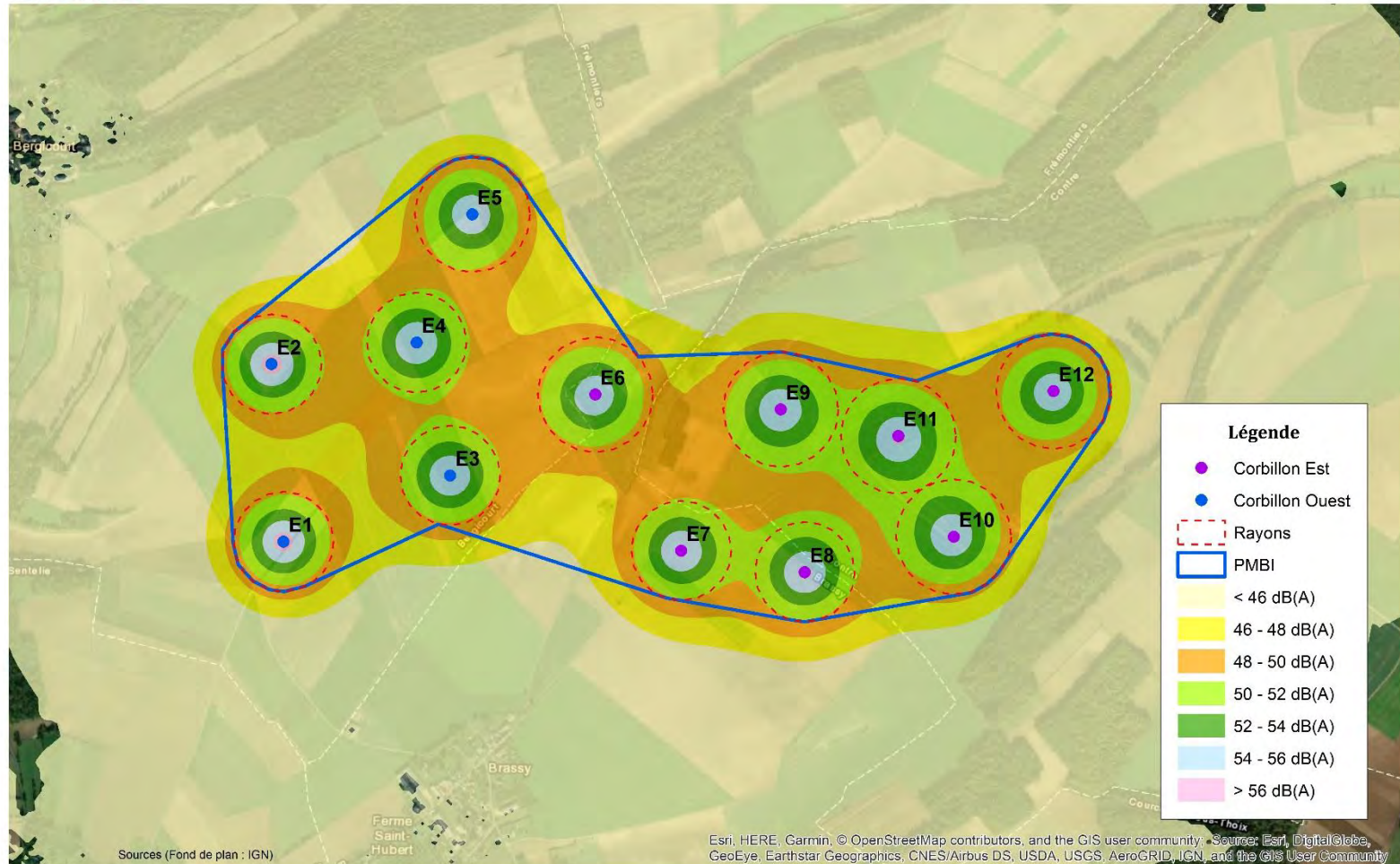
Niveaux sonores dans le périmètre de mesure de bruit de l'installation – Configuration Enercon en mode de fonctionnement normal pour un vent de vitesse standardisée de 10 m/s
